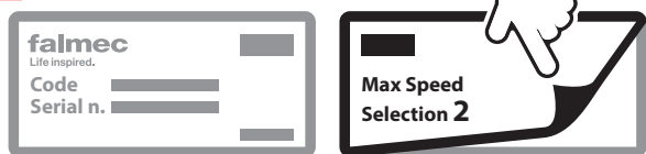
Fig. 2: Configure como máximo 2 velocidades:
