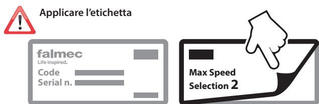
Fig. 2: Impostare massimo 2 velocità: Premere per 5 secondi i tasti + . Tutti i tasti lampeggiano. Entro 5 secondi, tenere premuto per 5 secondi il tasto . Se tutti i tasti si accendono fissi, l'impostazione è stata eseguita correttamente.
