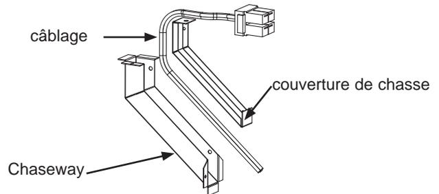
3. Alignez les trous de vis et fixez fermement les deux moitiés ensemble en utilisant une vis de type A au bas ou le long de la section du socle.
