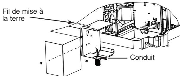
2. Si un fusible ou un porte-fusible est utilisé, la débouchure sur le côté de la boîte sert à monter un porte-fusible de type Buss. Assurez-vous que le fusible et le porte-fusible sont du même calibre que le circuit de dérivation. Les fils de connexion au fusible peuvent être soudés ou fixés à l'aide de raccords à sertir femelles (prises) de 1/4 po homologués UL.
