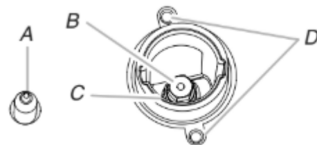
A. Igniter electrode B. Orifice spud C. Orifice spud holder D. Screws
