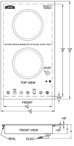
MODEL: CR2B15T1B CR2B15T2W 120V-60HZ 2400W MAX.
