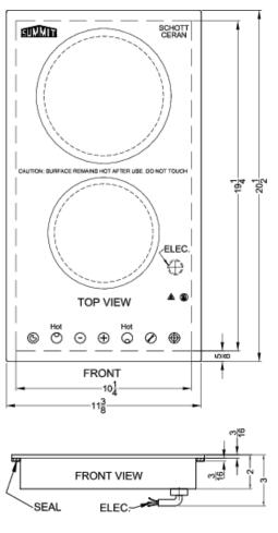
MODEL: CR2B23T3B CR2B23T4W 220-240V-60HZ 3000W MAX.
