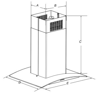
A. 12<sup>1</sup>/<sub>8</sub>"(30.8 cm) B. 13<sup>3</sup>/<sub>16</sub>"(33.5 cm) C. \*28<sup>5</sup>/<sub>8</sub>"(72.7 cm) min. 493/<sub>8</sub>"(125.4 cm) max. \*\*281/<sub>16</sub>"(71.3 cm) min. 441/<sub>2</sub>"(113.1 cm) max. D. 25<sup>11</sup>/<sub>16</sub>"(65.3 cm) E. 30"(76 cm) or 36"(91.2 cm)
