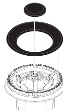
Quemador de Múltiples Anillos (en algunos modelos) Use este quemador para ollas grandes o para aplicaciones de cocción a fuego lento.
