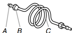
A. Virole de compression B. Écrou de compression C. Tuyau en cuivre ou en polyéthylène réticulé
