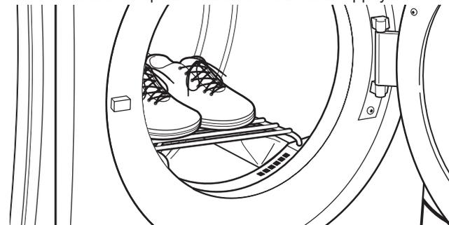
3. Placer les articles mouillés sur la grille de séchage. Laisser suffisamment d'espace entre les articles pour permettre à l'air de circuler. La grille de séchage ne bouge pas, mais le tambour pivote; veiller à laisser suffisamment d'espace entre les articles et à l'intérieur du tambour de la sécheuse. Veiller à ce que les articles ne pendent pas par-dessus les bords de la grille de séchage ou entre les barreaux de la grille.
